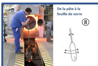
Le verrier souffle dans cette bulle tout en lui faisant faire un mouvement de balancier. La bulle s'allonge et forme une espèce de tube que l'on appelle *canon* ou *manchon*.
