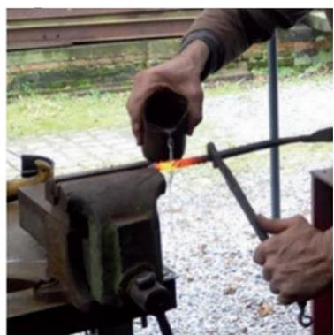
La barre de fer est placée dans un étau et torsadée à chaud, à l'aide d'une griffe que l'on tourne petit à petit.
