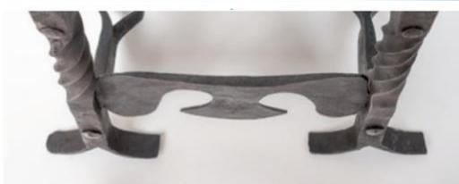
La tôle a été découpée à la main, à l'aide d'un burin. Sa tranche supérieure a été refoulée, c'est-à-dire élargie par tassement du métal, pour que l'on puisse y frotter la semelle de sa chaussure.
