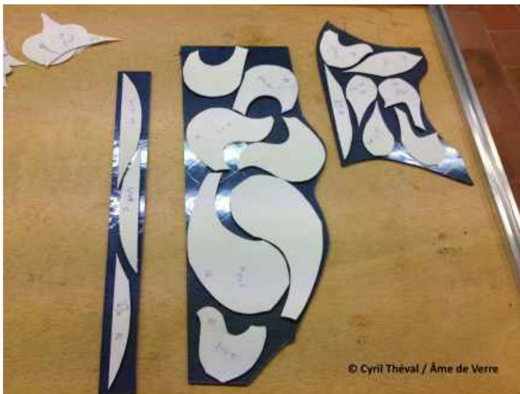
À l'aide du coupe-verre, également appelé pointe de diamant\*, on coupe les morceaux de verre en suivant le contour des calibres. Le contact de l'outil avec la feuille de verre produit un léger bruit. On dit que le verre « chante ». On s'aide d'une pince pour casser le verre à l'endroit où est passé le coupe-verre.
