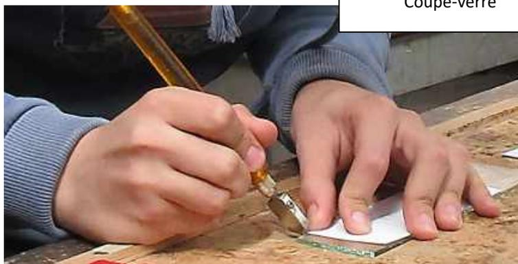
\* À l'origine, c'est un éclat de diamant qui était enchâssé à l'extrémité du manche. Aujourd'hui, il s'agit de carbure de tungstène, un alliage de carbone et de tungstène environ deux fois plus dur que l'acier.
