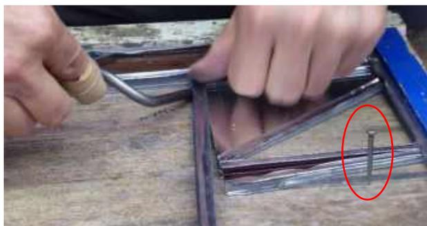
**7)** On soude les intersections des baguettes de plomb au fer à souder en faisant fondre une tige composée de 50% de plomb et de 50% d'étain. Les soudures sont effectuées sur les deux faces du vitrail. Elles permettent de fixer tous les éléments entre eux.
